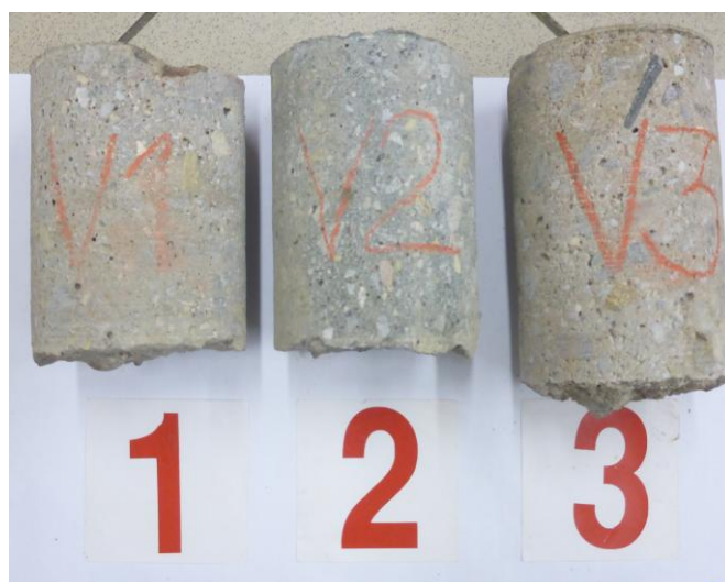
Obr. 3.1: Dokumentace vývrtů pro destruktivní zkoušky pevnosti v tlaku betonu opěr
